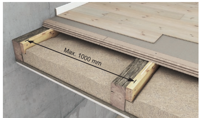
Figur 2 Klimagolv på äldre bjälklag.
